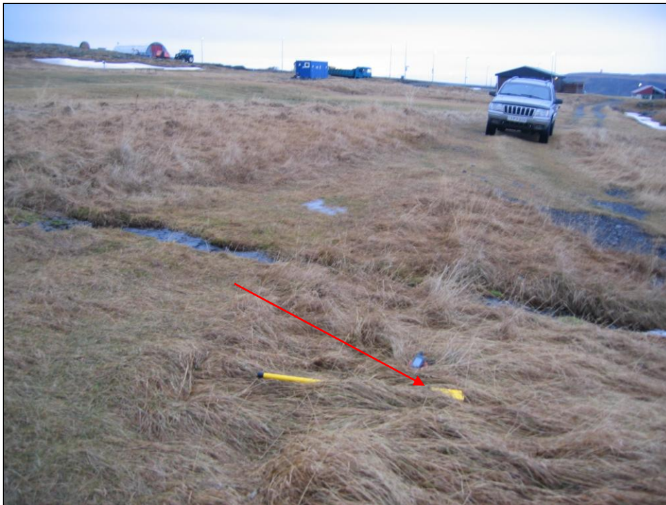
Mynd 19. Borhola DN-18. Boruð 9. ágúst 1998. Dýpi er 54 m. Holan er boruð með 34° halla í suðaustur.
