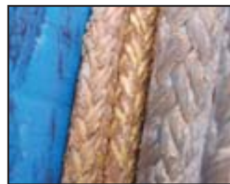
Þessi mynd er af gröndurum sem notaðir hafa verið á Vestmannaey í þrjú úthöld á úthafskarfa.
