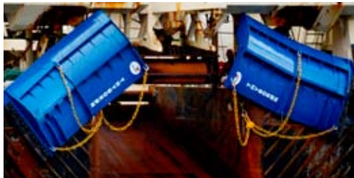
T14vf, V-laga botnhlerar á Hopen M-2-ho.
