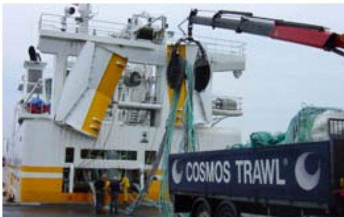
Áhöfnin á Ísafold hífir Glóriu Helix-trollið inná netvindu skipsins.
