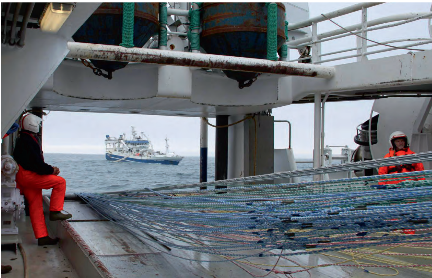
Á trolldekkinu á Tróndi í Gøtu. Finnur Fríði tekur við trollendanum hjá Tróndi þegar verið er að slaka út Glóriu Helix flottrolli frá Hampiðjunni. Mynd: www.vardin.fo
