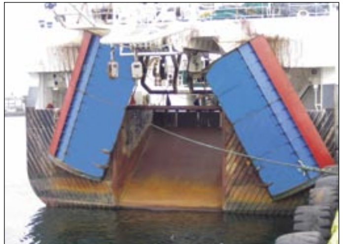
Risahlerar. FLS Poly-Ice flottrollshlerar 23 m 2 .
