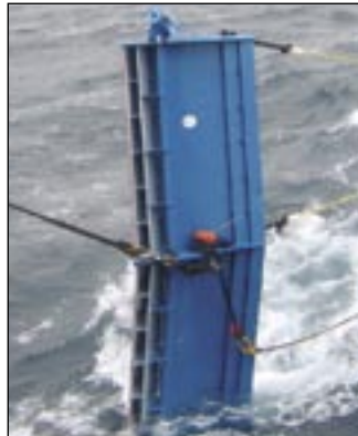
7 m 2 OpeX flottrollshleri með þremur bakstroffum.
