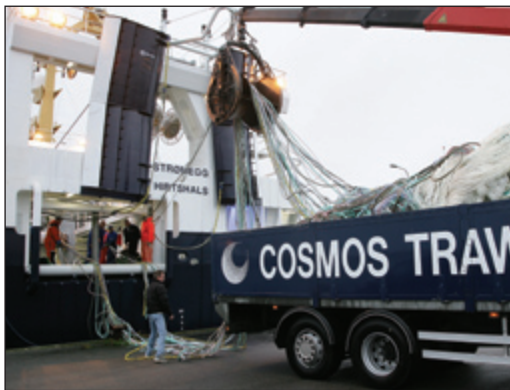
La red de arrastre Gloria Helix y la gran red de cerco con jareta subidas a bordo del Strømeegg
