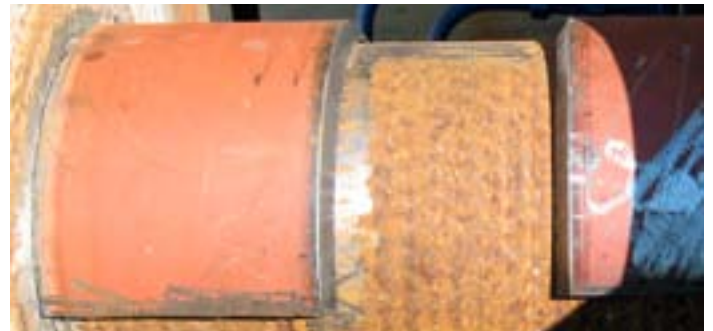
For økt styrke ble plater sveiset fast på kjernene til trålvinsjene.
