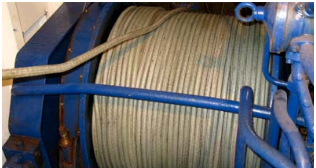
Her er 915 meter 22 mm Dynex Trålwarp blitt halt inn på en av trålvinsjene ombord i Claudia.
