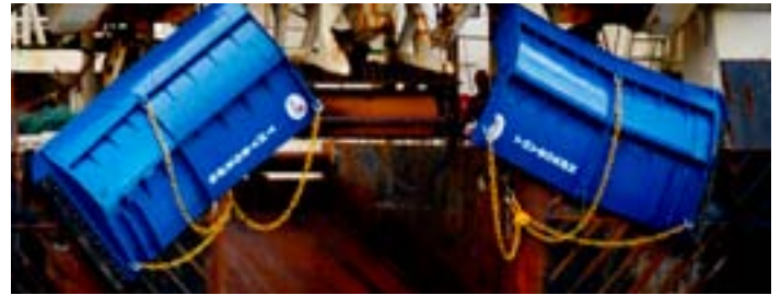
T14vf, V-formede bunntråldører på Hopen M-2-HO
