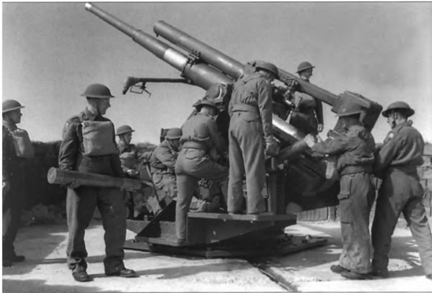
Bresk 3,7 þumlunga loftvarnabyssa í skotstöðu af sömu gerð og þær sem voru í Hvalfirði. Skotliði er tilbúinn við byssuna að hlaða hana nýrri kúlu og annar stendur reidubúinn með þá þriðju. Vel þjálfuð áhöfn gat skotið 6 skotum á mínútu. Myndin er tekin 25. júlí 1942 í Camp Brighton sem stóð í landi Grundar þar sem nú er Jörfi á Álftanesi. (NARA 111-SC-146920)
