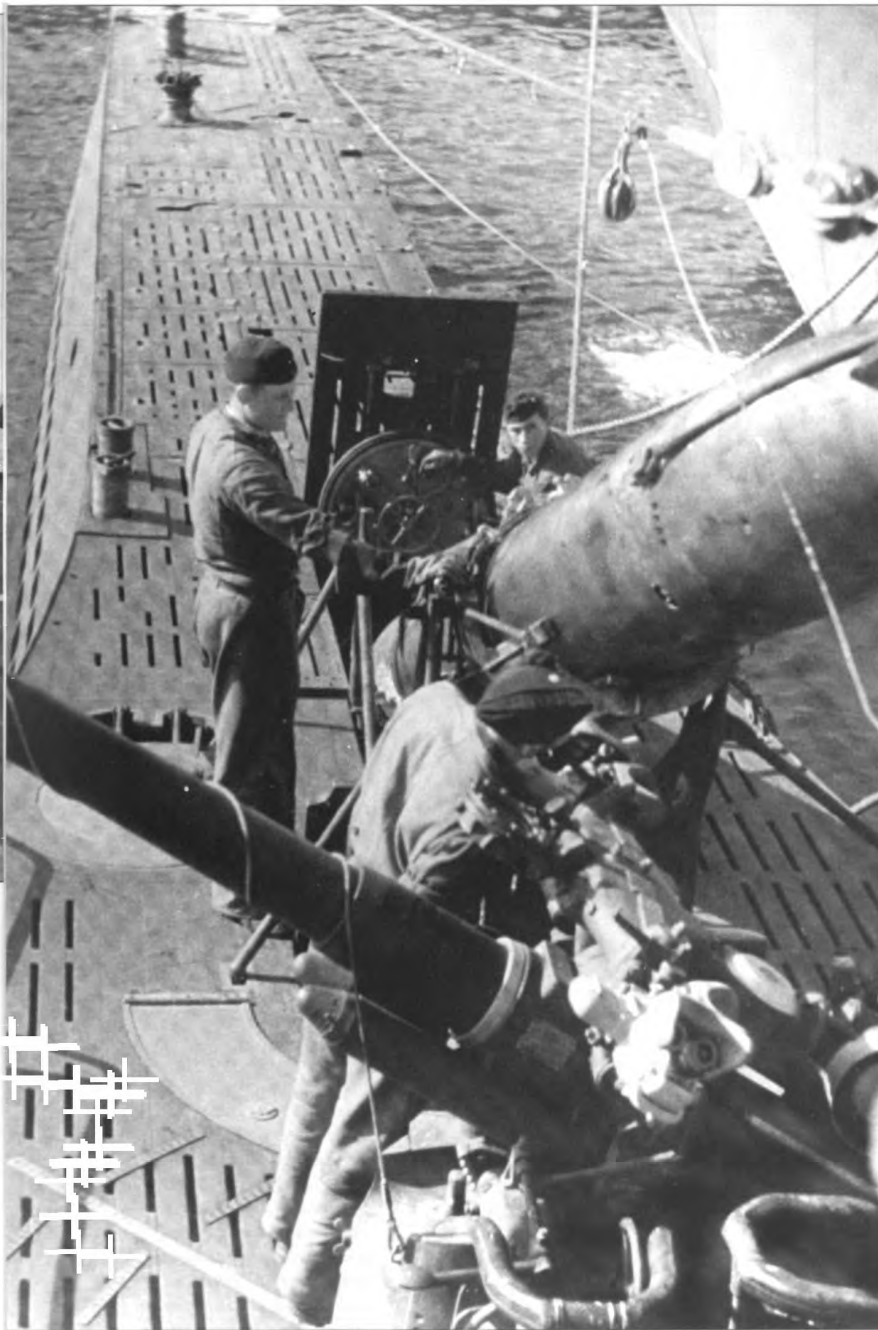
Tundurskeytin, sjálfstýrðir stálfiskar með sprengihleðslu, jafnvirði einbylissíðu í Þýskalandi, þörfnuðust stöðugrar umönnunar á langri leið svo þau mættu koma að gagni á örlogastundu. (NHC NH-71411)
