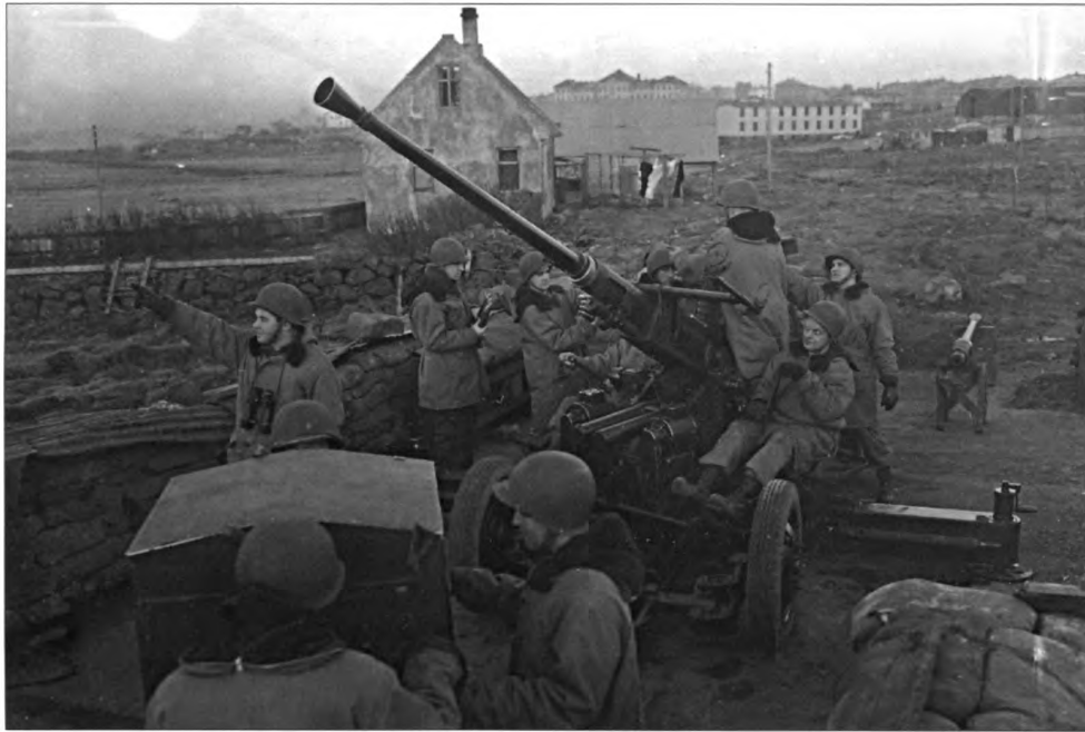
Hraðskeytt 40 mm Bofors-loftvarnabyssa. Myndin sýnir bandaríska skotliða í Camp Farm norðaustan við Reykjavíkflugvöll, skammt frá Vatnsmýrarvegi fimmtánda desember 1942. Fremst á myndinni er sjálfvirkt miðunartæki og í baksýn er Landspítalinn. Byssur af þessari gerð gátu skotið allt að 460 skotum á mínútu, en einungis upp í 7.500 feta hæð. Landhelgisgæslan bjó skip sín samskonar byssum árið 1990 gegn landhelgisbrjótum. (NARA 111-SC-360873)
