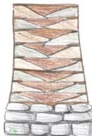
Wenn die Wand **einfach gemauert** ist, dann stößt Erdstoff gegen den Grassodenverband und es muss darauf geachtet werden, das lose Füllmaterial zwischen Verband und unbewegtem Erdstoff sehr gut zu verdichten. Zur Bindung werden Grasstreifen längs zwischen die Ziegel gelegt und in jeder zweiten bis vierten Lage werden Grasplatten quer eingebracht. Zeichnung von Sigríður Sigurðardóttir.
