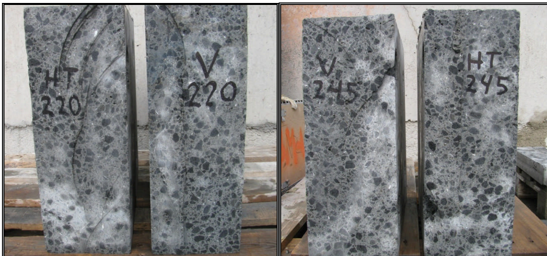
Mynd 5. Myndin sýnir veggina í áfanga tvö. Veggirnir vinstra megin eru með sigmáli 220 mm og veggirnir hægra megin með sigmáli 245 mm. "V" stendur fyrir venjulegur víbrator og "HT" fyrir hátíðni víbrator. Ekki er unnt að greina neinn afgerandi aðskilnað í veggjunum.
