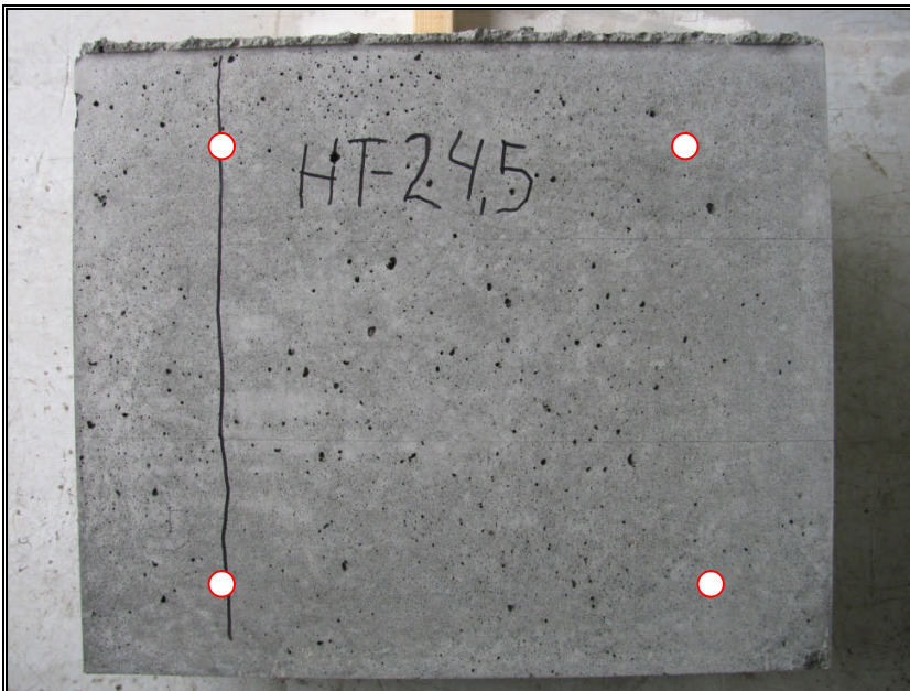
Mynd 2. Veggur í áfanga tvö með sigmáli 245 mm og víbraður í 6 sek með há tíðni vibrator. Vibratornum var stungið niður í vegginn þar sem svarta lóðréttu línan er. Rauðu hringirnir sýna hvar kjarnarnir voru boraðir úr veggjunum.
