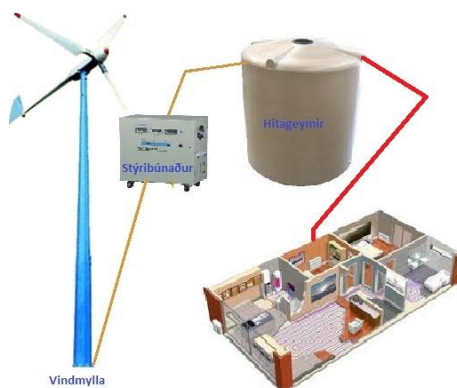
Mynd 6: Vindmylla til upphitunar á íbúðarhúsnæði Heimildir: Af vef Rafey ehf
