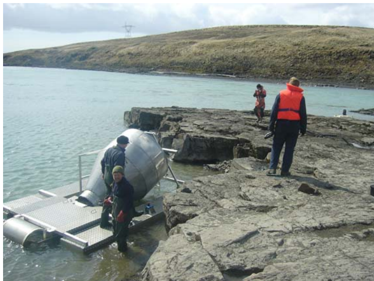
Ljósmynd 1. Snúningsgilda sett saman í Þjórsá þann 11. apríl 2005.
