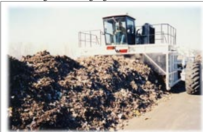
Mynd 2.1-2 Múgasnerill að verki. Aðrar gerðir finnast. Sá múgur sem hér sést er nokkuð stór miðað við það sem almennt gerist. Nýlegar finnskar rannsóknir benda til að hagstæðasta stærð múganna sé minni en 1,5 m í upphafi jarðgerðar 6 .
