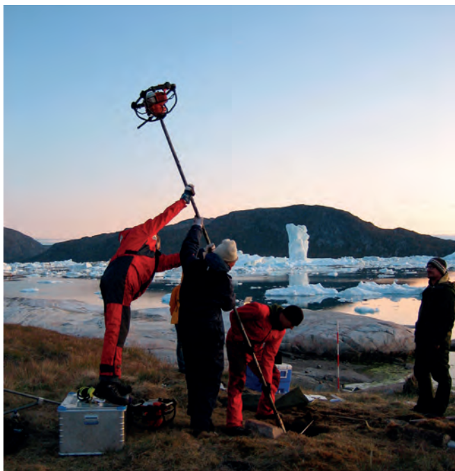
Installering av utstyr for lokal overvåkning av jordtemperatur, opptining og fuktinnhold i frosne kulturlag. Qajaa, Grønland.
