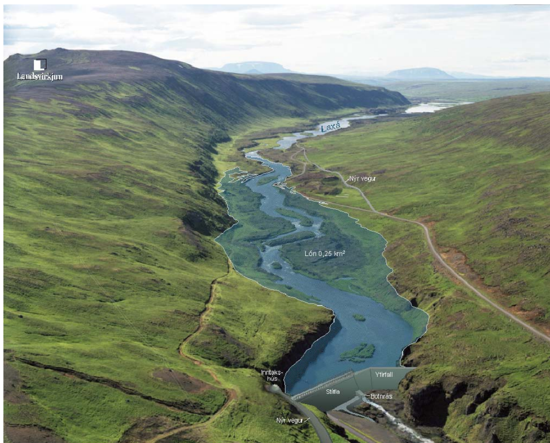
9. mynd. Hækkun Laxárstíflu um 10m og lóns í 118 m.y.s. Horft til suðurs yfir stíflu og lónsstæði. (Mynd fengin frá Landsvirkjun).
