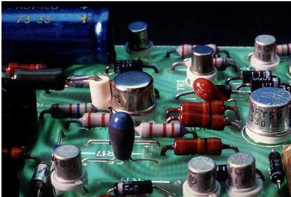
Mynd 2.3: Smárar (transistors) á stýriborði reykskynjara. (Mynd: Encarta).
