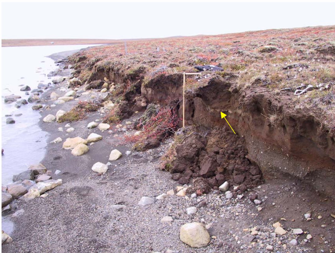
21. Ljósmynd. Rofbakki á sniði 3, 18. september 2002. Hnausar og moldarfyllur undir bakkanum eru merki um mikið öldurof sem líklega varð í sunnan óveðri þann 1. september, en þá gekk bakkin inn um allt að 3 metra. Bakkin er orðinn um 1 m hár og er rof komið niður í jökulruðning undir jarðveginum, en skilin þar á milli koma vel fram á myndinni. Frá árinu 1997 hefur meðalrof numið 65 cm ár ári. Ör bendir á ljóst öskulag í jarðvegi, sem er meginuppspretta sands sem fokið hefur á land í vikinú innar með ströndinni (Ljósm. Borgþór Magnússon)
