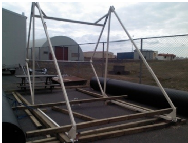
Flekinn í smíðum. Lyftigrind í reistri stöðu, flotrórin til hliðar. Vantar hverfil, gálga, skýli, pall o.fl.
