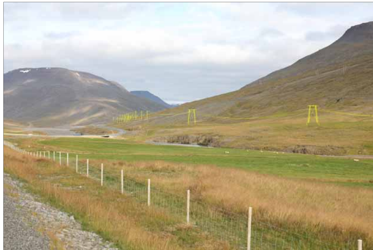
Mynd 52b Úr Norðurárdal í nágrenni Fremrikota. Mynd sýnir línu þar sem möstur og leiðarar eru sýnd með verulega áberandi lit. Fjarlægð í mastur lengst til hægri er 750 metrar, 1 km í næsta og svo 1,3 km í hornmastur.
