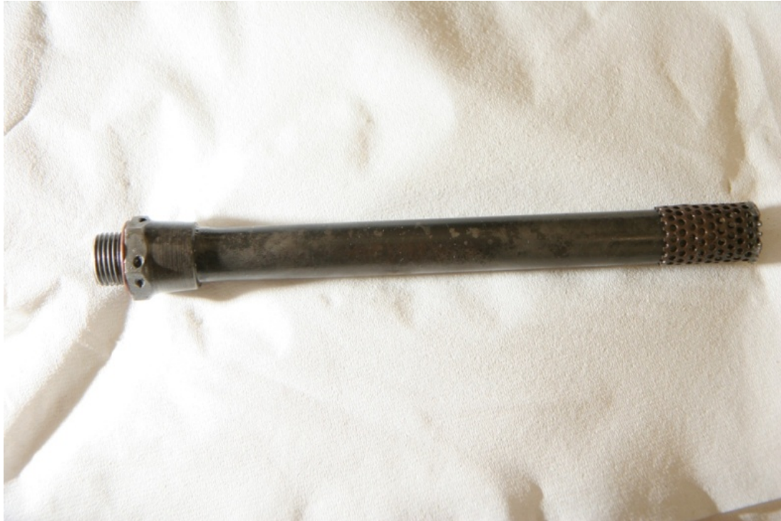
Mynd 3: Rör sem ætlað er að flytja olíu upp úr oliupönnu. Rörið hafði losnað og lá í botni oliupönnunar.
