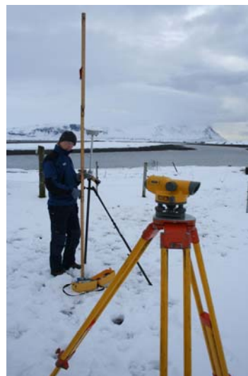
14. mynd. Hæð var mæld inn með GPS tæki í punkti. Síðan var hallamælt frá punkti að útihúsum við Ferjukot með álestri af stöng í gegnum kíkí á þrífót. Leiðbeinandi, Bogi Brynjar Björnsson, heldur á stöng og GPS tæki.
