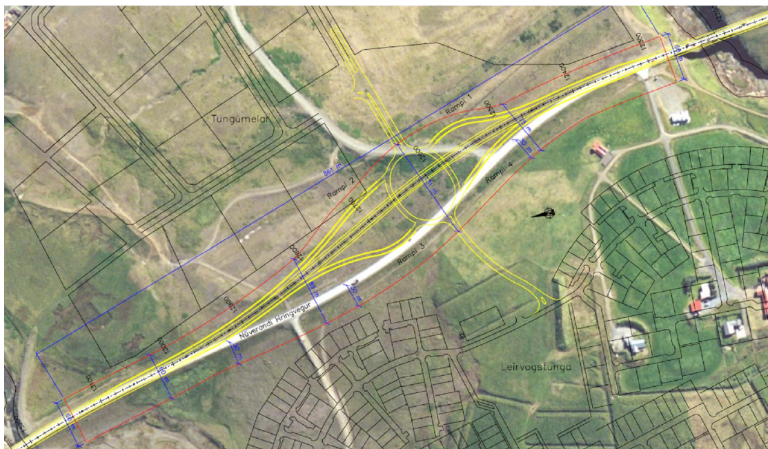
Mynd 4. Fyrirhuguð lega Hringvegjar og staðsetning mislægs hringtorgs (gular línur). Rauðar línur sýna framkvæmdasvæðið en bláar eru mællínur. Lega núverandi Hringvegjar liggur í gegnum myndina þvera frá hægri til vinstri. Skipulag byggðar í Leirvogstungu er neðan Hringvegjar á myndinni og Tungumelar að ofan.
