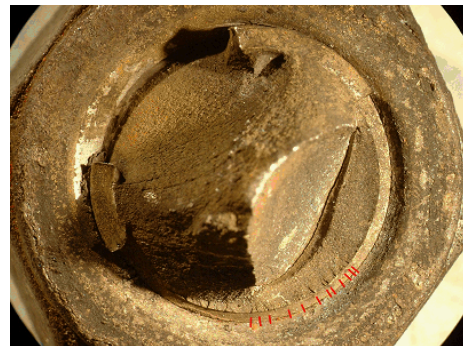
Mynd 5. Ró og brot af bolta nr. 1. Á myndinni má sjá nokkur ummerki um þreytubrot merkt með rauðu.
