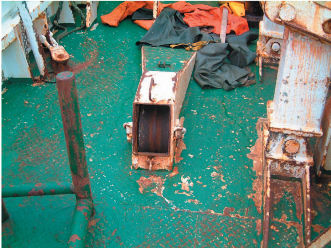
E3: Víralúga fyrir snurpuvír á efra þilfari loðnuskips, lok vantar; opið niður.
