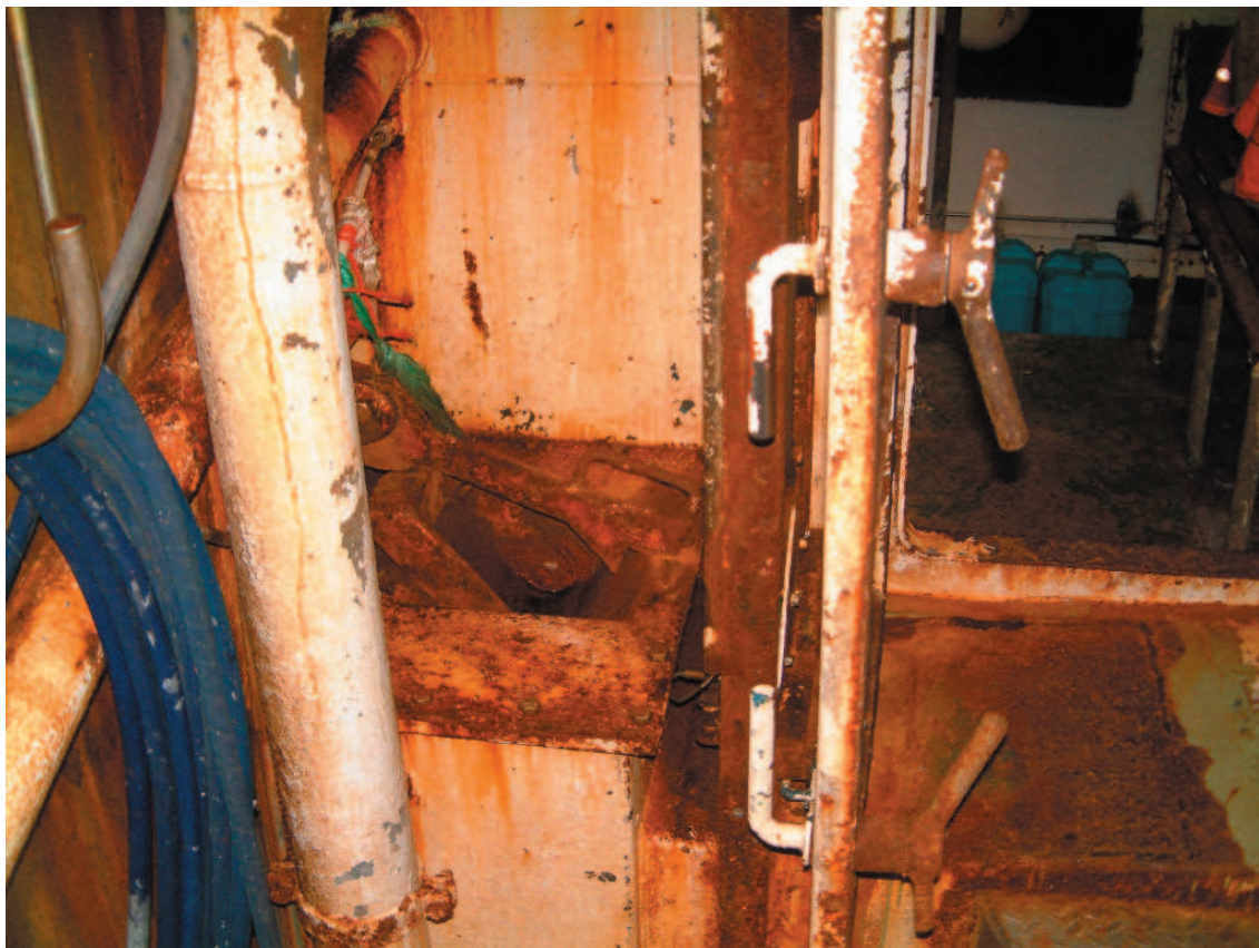
D3: Slæmt ástand vatnspéttra hurða og lokunarbúnað slógstokka fyrir borð.
