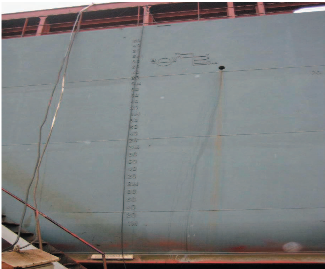
E8: Djúpristumerki og hleðslumerki miðskips á litlu kaupskipi fyrir heilfarma.
