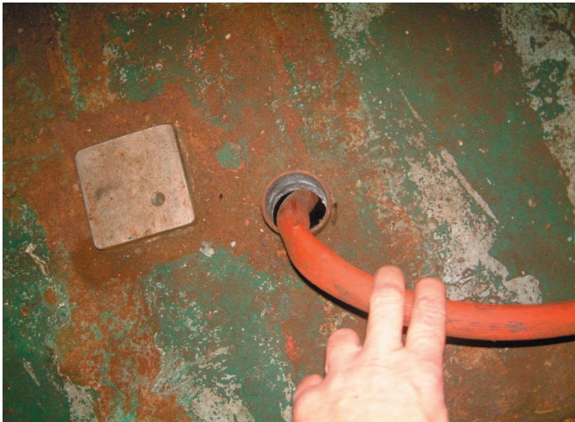
C3: Gegnumtak fyrir spúslöngu niður í lest í aðalþilfari loðnuskipis
