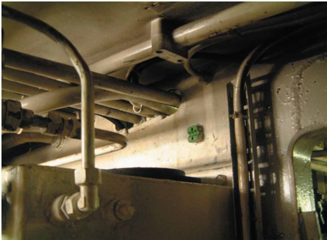
C1: Kaplar og rör færð gegnum óþétt op skorið í vatnsþétt þil.
