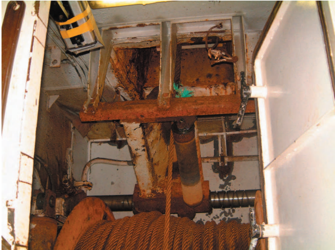
D4: Opin og óvarin víraop frá vindu á neðra þilfari til efra þilfars.
