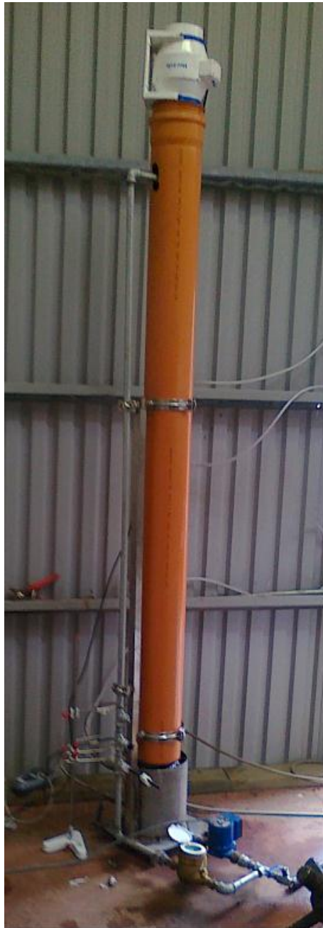
Mynd 2 Tilraunakæliturn uppsettur
