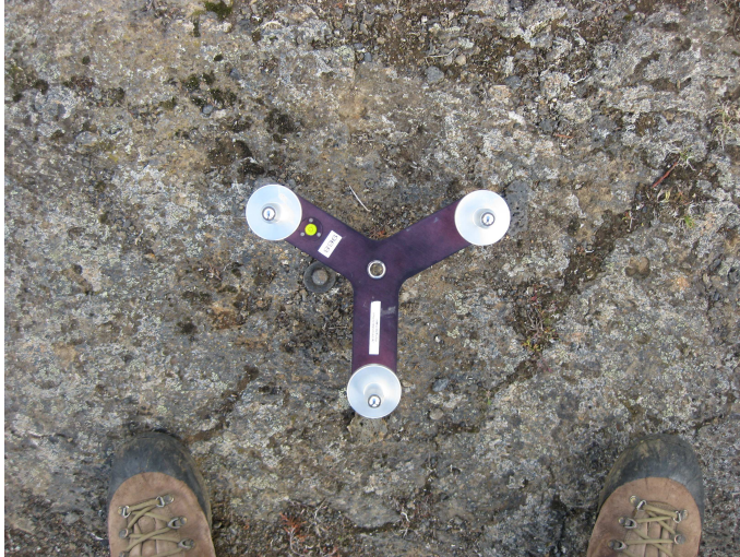
Mynd 3: Þristúfur og fastmerki. Merkið, koparbolti með skífu, er neðan við litla, hvíta ferninginn á arminum sem veit til vest-norðvesturs.
