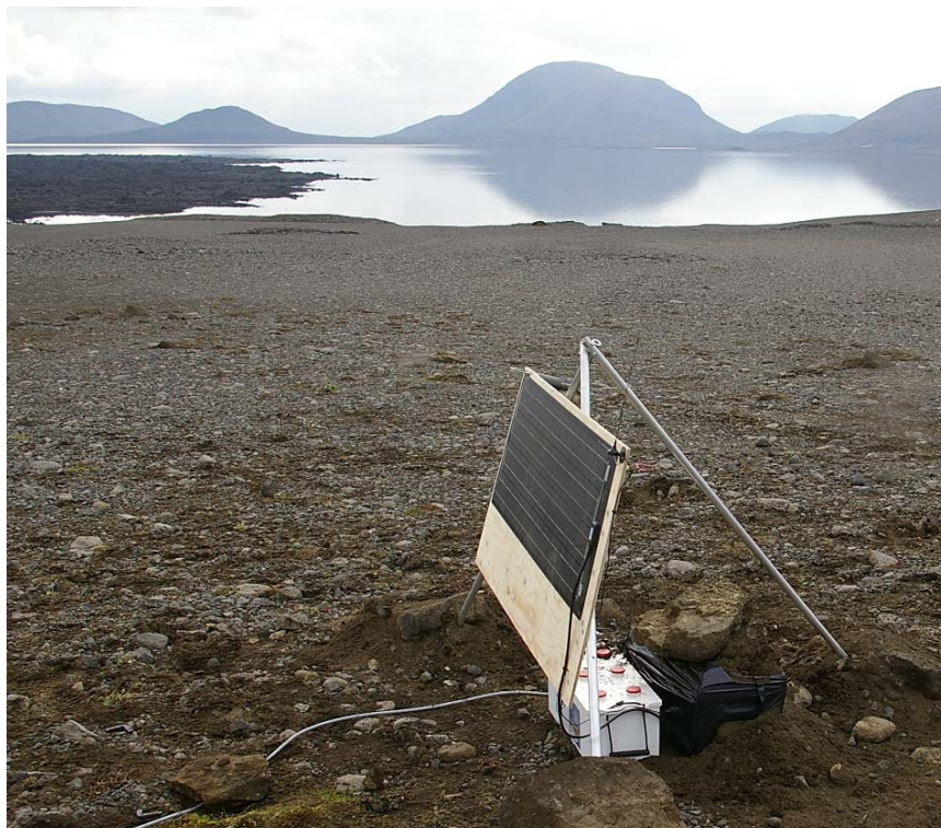
Mynd 3. Sólarrafhlaða, lofnet og rafgeymir stöðvarinnar hga. Hágöngulón og Nyrðri Háganga í baksýn.
