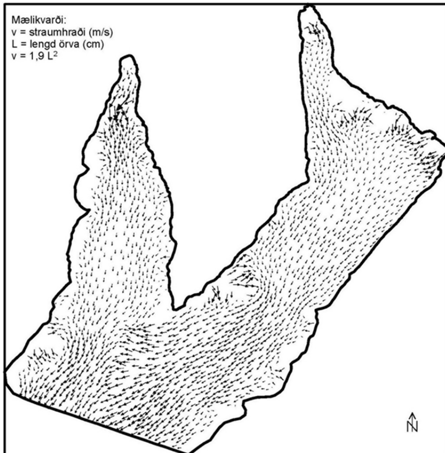
Mynd 6.9.4. Mjóifjörður og Kjálkafjörður. Grunnástand. Straumhraði. Útfall (Verkfræðistofan Vatnaskil, 2011).
