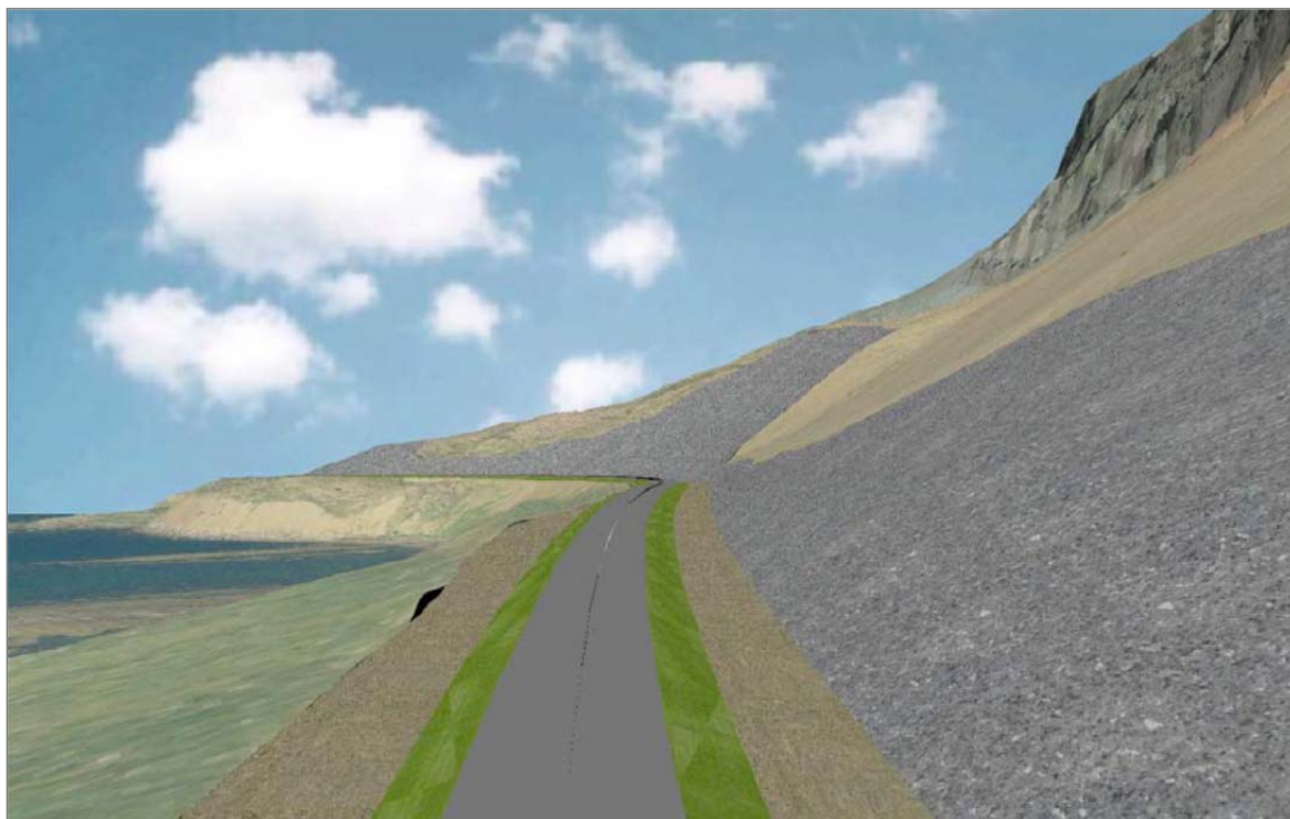
Mynd 6.10.37. Fyrirhugað vegstæði inn með Kjálkafirði, stór skeringarsvæði eru ofan vegstæðisins og við Litlaneshraun. Sama sjónarhorn og mynd 6.10.36. Grænt= fylling, grátt= skering, brútt yrrjótt= landmótunarsvæði (Myndvinnsla: Halldór Sv. Hauksson).
