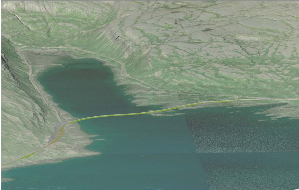
Mynd 6.10.11. Veglína A um Mjóafjörð Grænt=fylling, grátt yrjött=skering og brúnt yrjött=landmótunarsvæði (myndvinnsla Halldór Sv. Hauksson).
