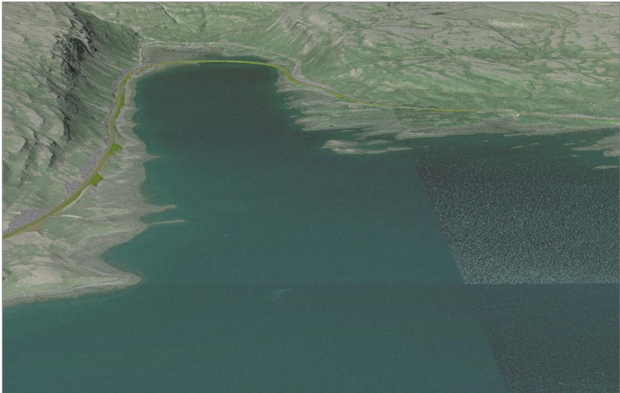
Mynd 6.10.16. Veglína B um Mjóafjörð (innri þverun). Grænt=fylling, brúnt yrjótt= landmótunarsvæði og grátt yrjótt=skeringar (Myndvinnsla Halldór Sv. Hauksson).
