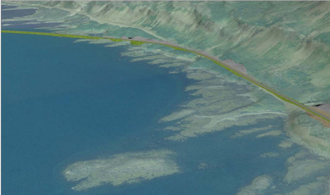
Mynd 6.10.42. Austari hluti þverunnar um Kjálkafjörð. Grænt= fylling, grátt= skering (Myndvinnsla: Halldór Sv. Hauksson).
