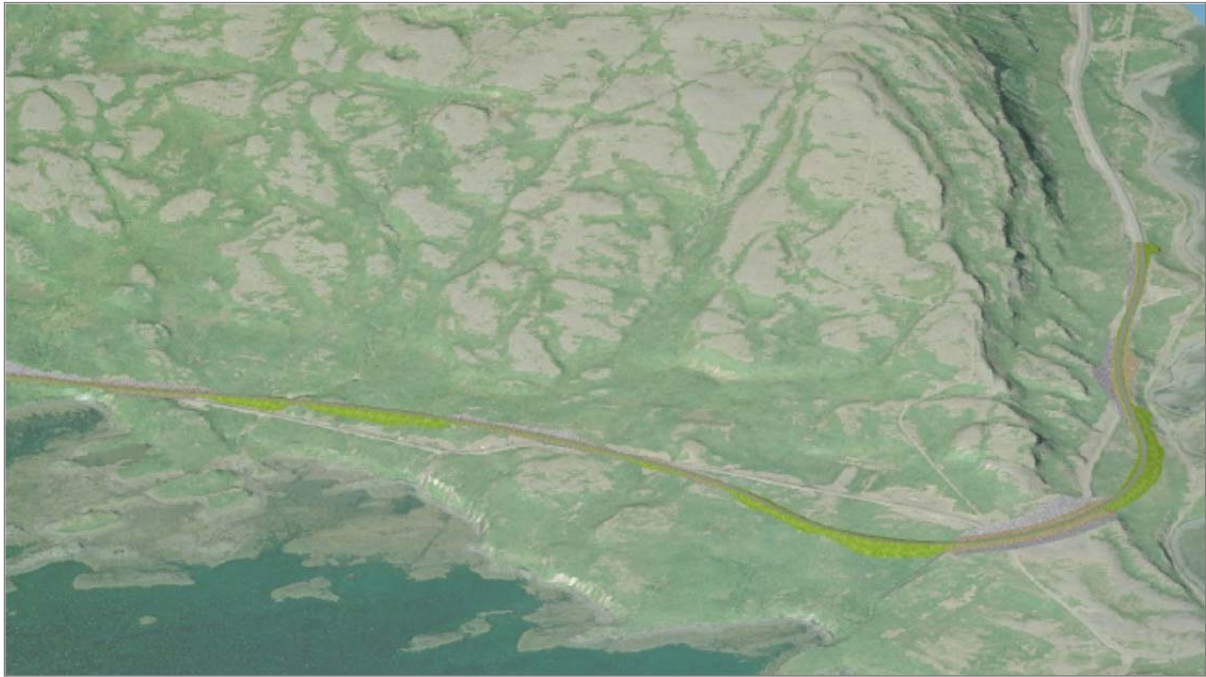
Mynd 6.10.2. Veglína á svæðum I og II (stöðvar -1600 að 1500). Grænt=fylling, grátt yrjótt=skering og brúnt yrjótt= landmótunarsvæði (myndvinnsla Halldór Sv. Hauksson).
