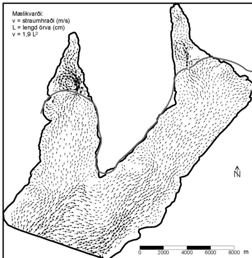
Mynd 6.9.3. Mjóifjörður og Kjálkafjörður. Með brú. Straumhraði. Aðfall (Verkfræðistofan Vatnaskil, 2011).
