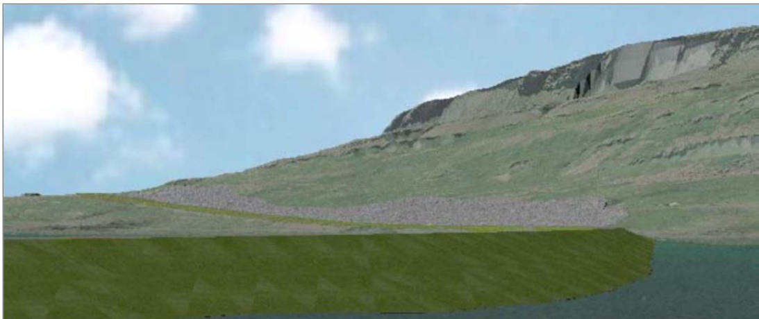
Mynd 6.10.20. Ytri þverun Mjóafjarðar, veglína A, og skeringarsvæði innan við Borgarnes. Grænt= fylling, grátt= skering, brúnt yrrótt= landmótunarsvæði (Myndvinnsla: Halldór Sv. Hauksson).
