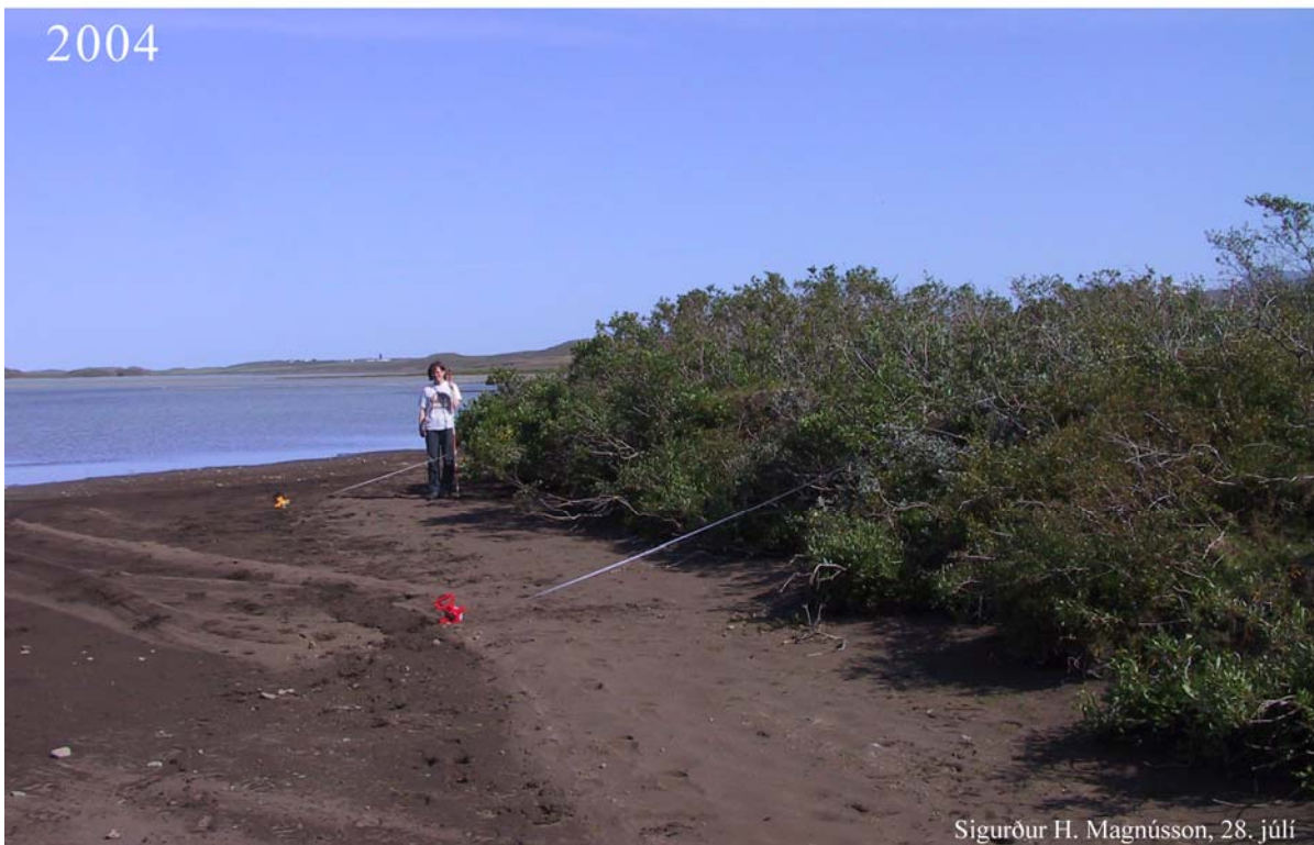
53.–54. ljósmynd. Landbrot við reit D í Finnsstaðanesi (efri mynd). Þar brotnaði á árunum 1994–2004 að meðaltali 31 cm árlega af bakka fljótsins. Neðri myndin sýnir landbrot við reit A í Egilsstaðanesi. Á árunum 1984–2004 eyddust alls 2,4 m af bakkanum eða 11 cm á ári.
