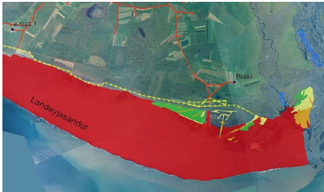
Mynd 11.1 Jarðvegsrof í nágrenni Bakkafjöruhafnar og vegtengingar á Landeyjasandi, rauður litur táknar mjög mikið rof (Elín Fjóla Þórarinsdóttir og Ingibjörg Sveinsdóttir, 2006).
