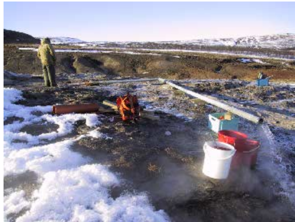
Rennslismælir í frárennsli Geysis. Járnrör leiða vatnið úr rauf norðan í skálinni.
