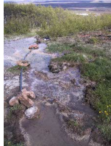
Rennslismælir við Háahver. Gagnasöfnunartæki var undir hvíta kassanum. Útfellingar voru til vandræða í rörinu þrátt fyrir góðan rennslis-halla.
