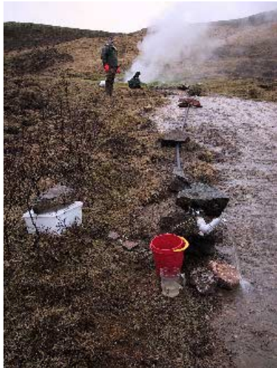
Rennslismælir við Háahver. Gagnasöfnunartæki var undir hvíta kassanum. Útfellingar voru til vandræða í rörinu þrátt fyrir góðan rennslis-halla.
