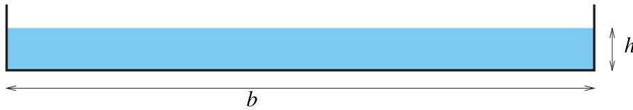
Mynd 4. Snið flóðfarvegar þar sem dýpi flóðs, h er mun minna en breiddin, b .
