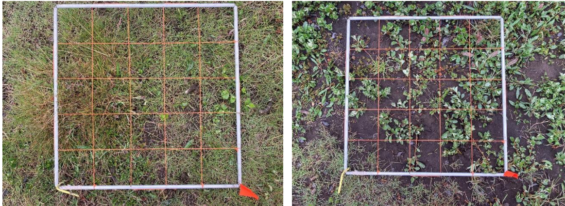
Mynd 6. Ljósmyndir af mælireitum í föstu mælniði AM024_02. Mynd a sýnir reit AM024_02d þar sem meðaláfok mældist 0,7 cm en mynd b sýnir reit AM024_02e sem er fjærst lóninu en þar mældist meðaláfok 2,26 cm.
