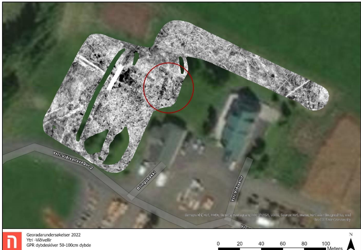
Mynd 18. Djúpsneið frá Víðivöllum ytri. Rauði hringurinn sýnir hvar mannvirki fannst norðan núverandi bæjarhúsa.
