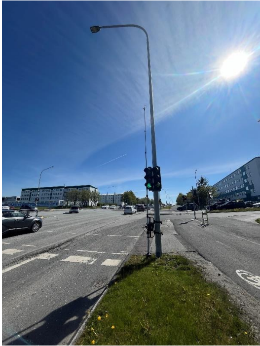
MYND 5 Miovision umferðartalningarbúnaður samanstendur af útdraganlegum staur sem festur er við ljósastaur eða skiltastaur. Efst á staurnum er myndavél og neðst er kassi með tölvu.
