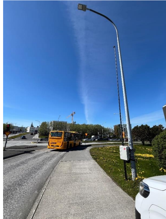
MYND 5 Miovision umferðartalningarbúnaður samanstendur af útdraganlegum staur sem festur er við ljósastaur eða skiltastaur. Efst á staurnum er myndavél og neðst er kassi með tölvu.
