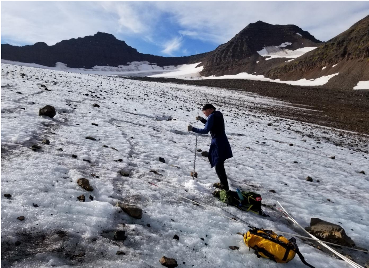
4. mynd. Borað fyrir nýjum leysingastikum á sporði Búrfellsjökuls í haustmælingaferð 2021. Ljós. Skafti Brynjólfsson, 9. september 2020.
