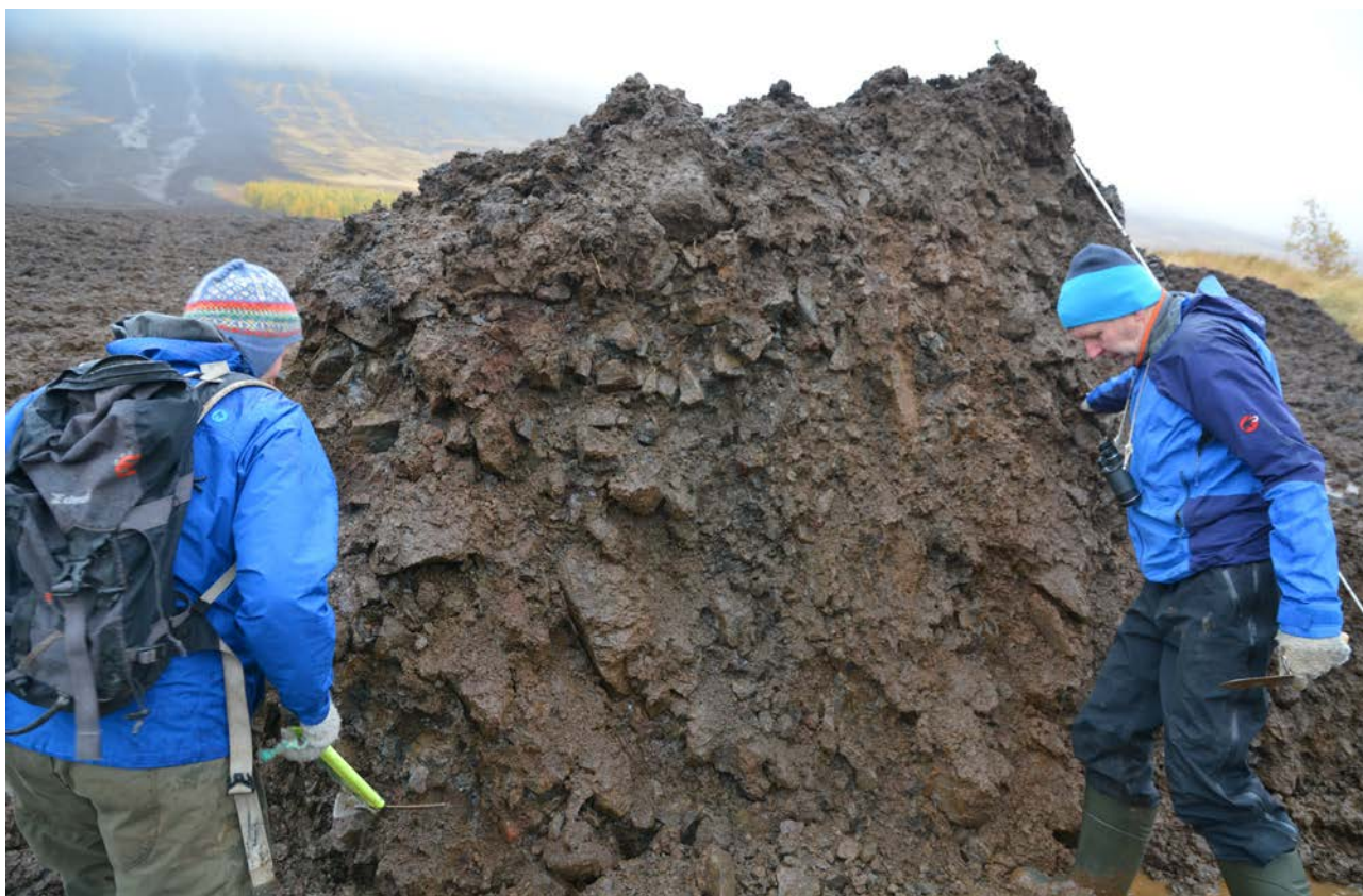
21. mynd. Einn af samanfrosnu setklumpunum sem komu niður með Gilsárskriðunni 6. október 2020. Setklumpurinn samanstendur af grófu köntuðu grjóti, holrými og ísmagn hans var áætlað meira en 20% af rúmmáli. Ljós. Skafti Brynjólfsson, 7. október 2020.
