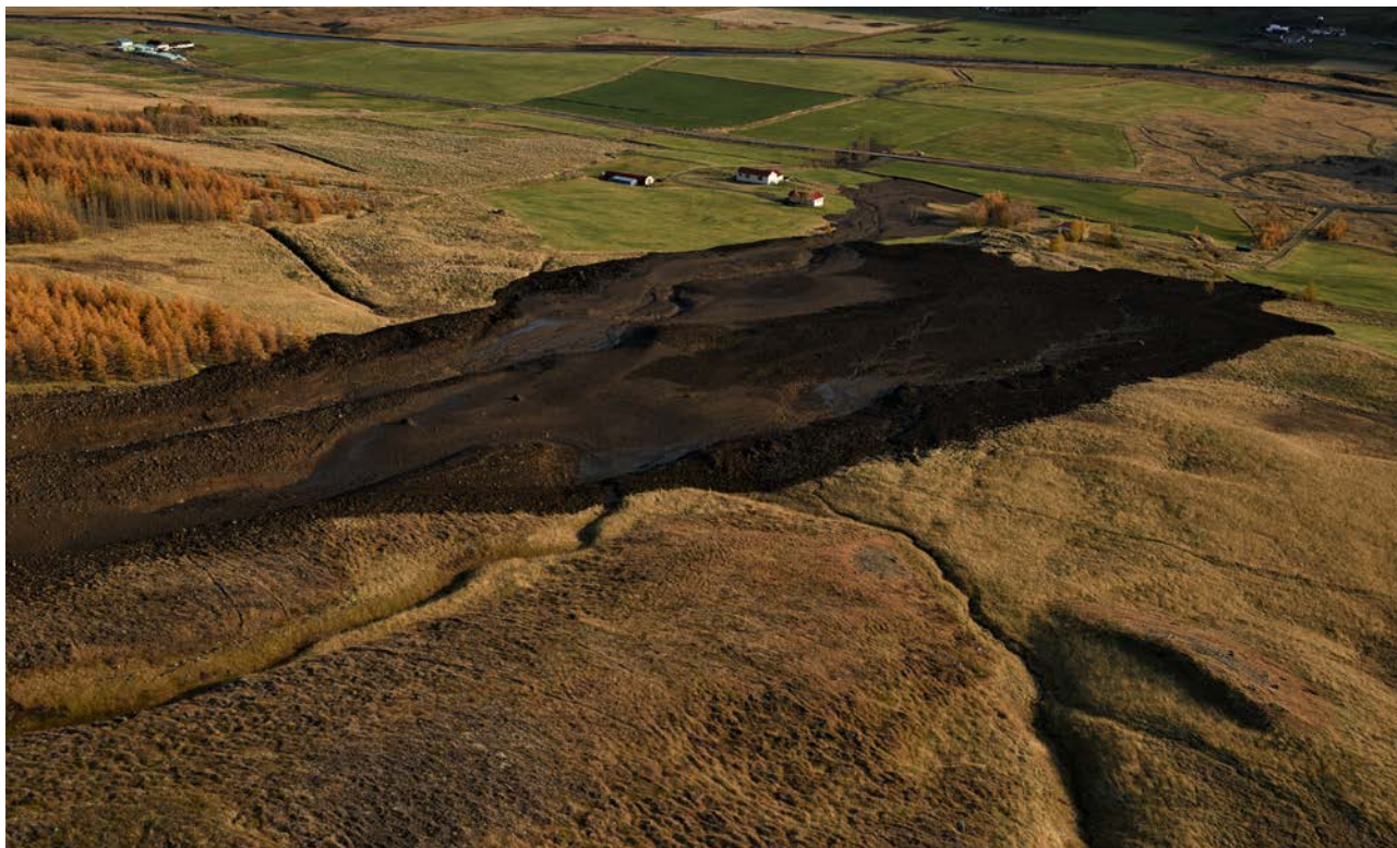
23. mynd. Orsök skriðunnar sem féll nærri bæjarhúsum á Gilsá í október 2020 kann að hafa tengst breytingum á ástandi sífrera í setbunka í rúmlega 800 m hæð í Hleiðargarðsfjalli. Ljós. Birgir Vilhelm Óskarsson, 13. október 2020.
