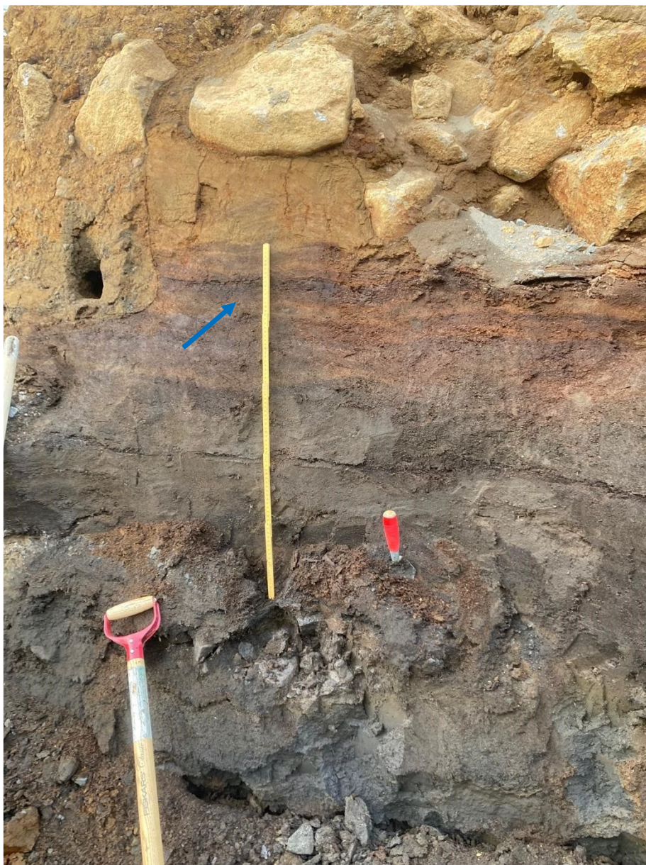
Mynd 2. Dökkur mór (við tommustokk) og grár leir með grjótdreif undir (neðan tommustokks). Efsti hluti mósins er litaður af mýrarauða. Þar fyrir ofan er seinni tíma fylling með grjóti. Blá ör bendir á gjóskulagið Heklu-Ö.
