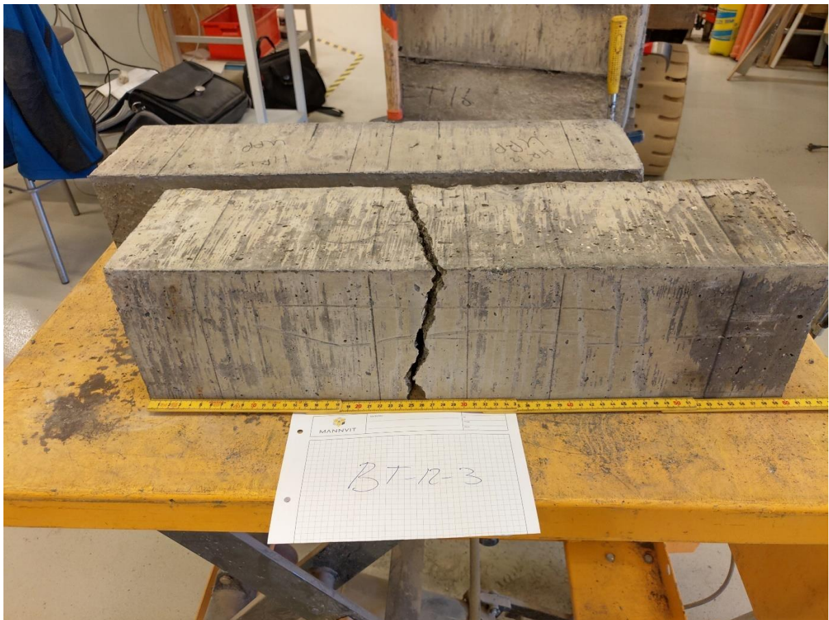
Mynd 46. Lýsandi mynd af bita með Basalttex BCS17-25.4-KV1 12kg/m 3 í C30/37:XC1-S2-8/16 steypu eftir brot.
