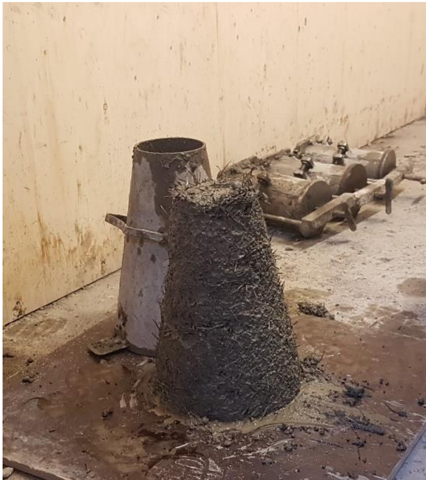
Mynd 3. Sigmálsmæling á trefjasteypu.
