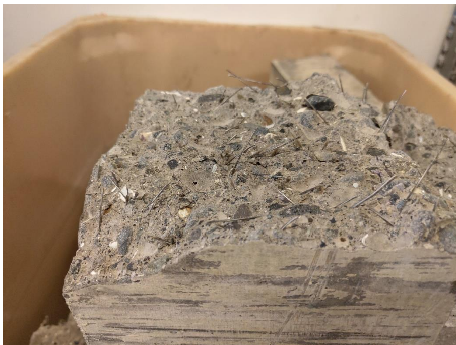
Mynd 28. Reforcetech Minibars sýni eftir brot.
