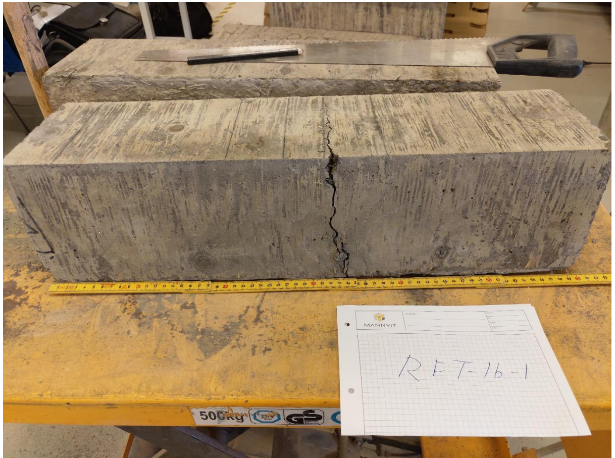
Mynd 40 Biti með Reforcetech Minibars 16\text{kg}/\text{m}^3 í C30/37:XC1-8/16 steypu
