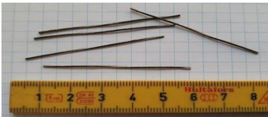
Mynd 13. Reforcetech minibar stöngin er stíf basalttrefjastöng.
