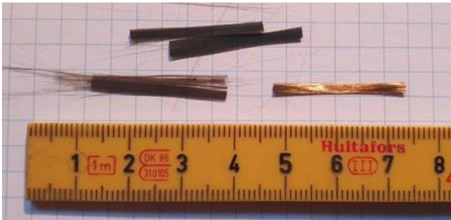
Mynd 15. Basalttex BCS17-25.4-KV1, samsett úr örfínum þráðum í knippum.
