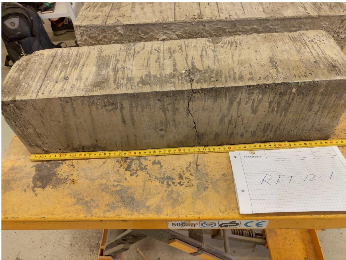
Mynd 30. Biti með Reforcetech Minibars 12kg/m 3 í C30/37:XC1-8/16 steypu.
