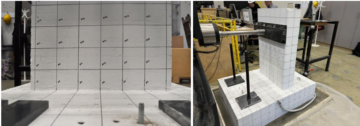
Mynd D 13: FSL-LS eftir lotu 1 (hlutfallsfærsla 0,10%). Engar sjánlegar skemmdir.
