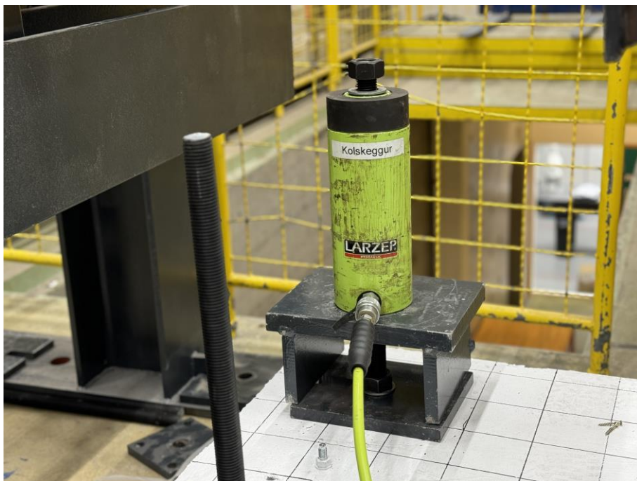
Mynd 3-3: Uppsetning vökvatjakks til að eftirspenna snitteina..
