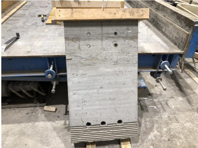
Mynd 2-14: FSL-SS daginn eftir steypu. Hrjúfi flöturinn sem stingst ofan í sökkulinn sést vel.
