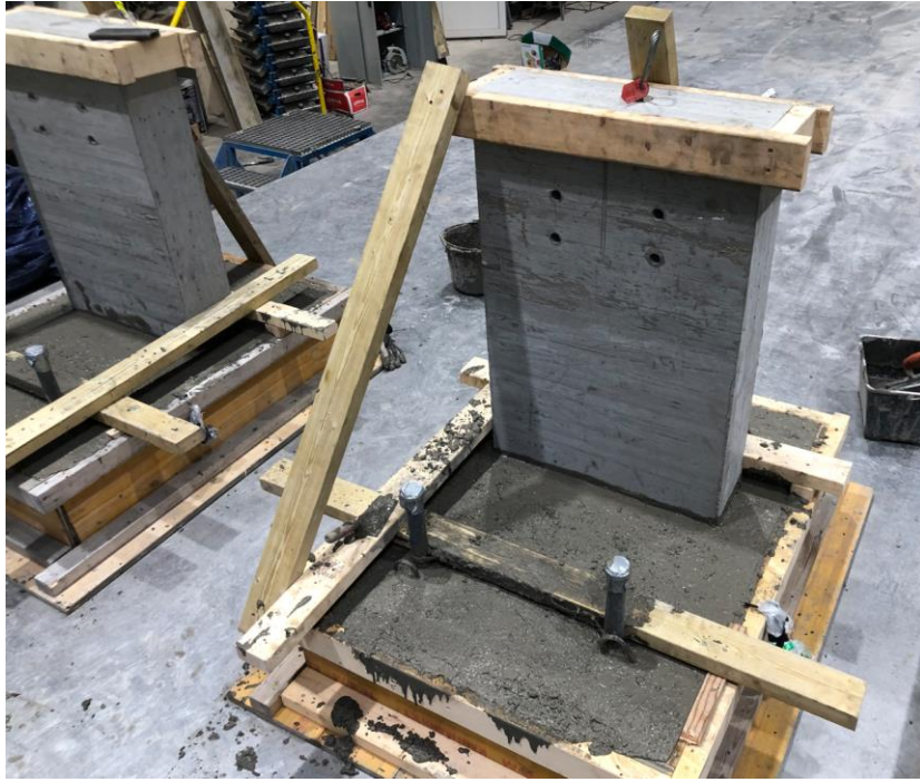
Mynd B 8: Prófstykki FSL-SS eftir steypuvinnu. Einnig má sjá hluta prófstykkis FSL-LS eftir steypuvinnu vinstra megin á mynd.
