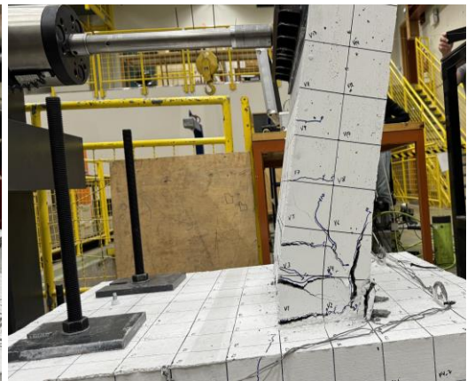
Mynd D 12: FSL-SS eftir lotu 12 (aukalota: 120mm færsla, 16,4% markmiðshlutfallsfærsla). Þrjú lóðrétt kambstál í vegg slitnuðu við lotuna.
