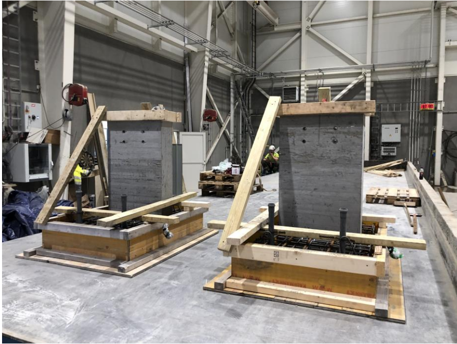
Mynd 2-16: Búið er að koma veggjum fyrir í sökkulgrind og bæði stykki klár til steypu.
