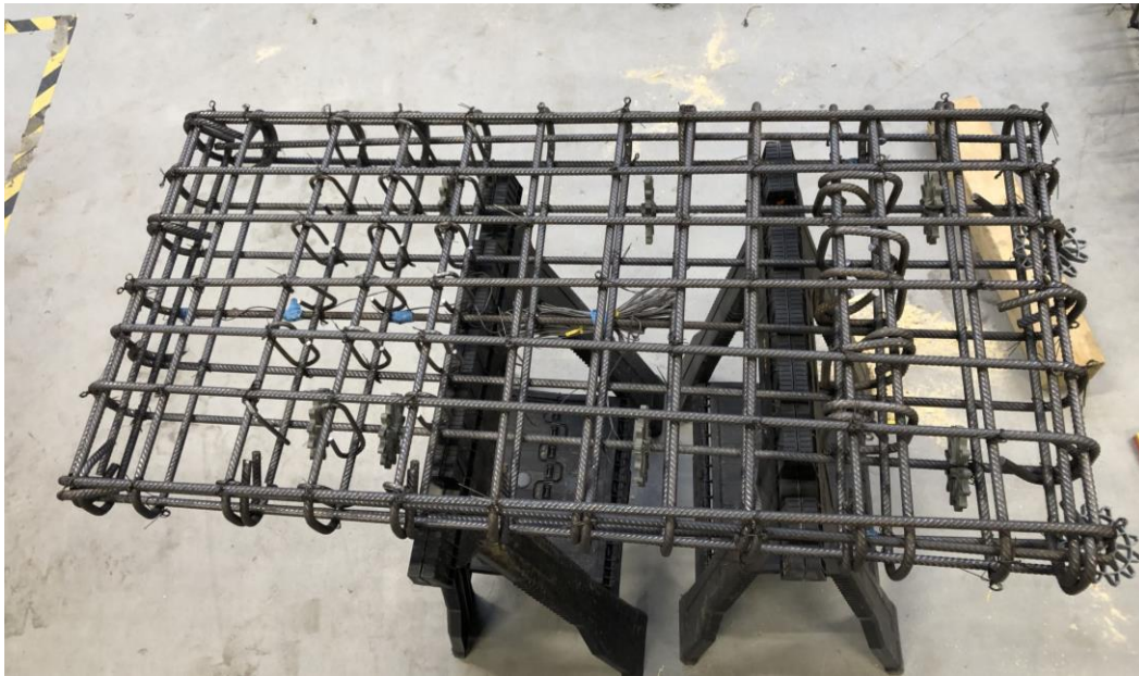
Mynd 2-10: Járnagrind veggjar. Streitunemar eru varðir með bláu límbandi.
