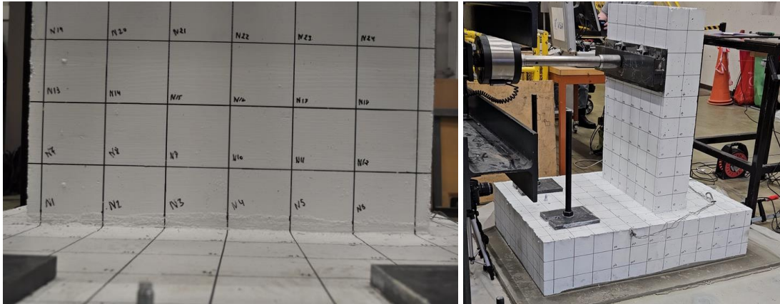
Mynd D 1: FSL-SS eftir lotu 1 (hlutfallsfærsla 0,11%). Engar sjáanlegar skemmdir.
