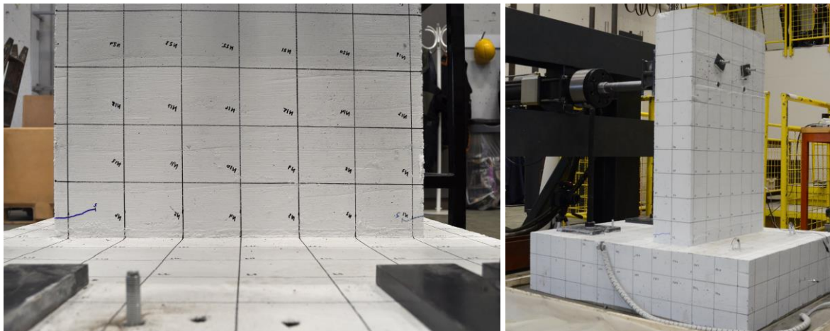
Mynd D 14: FSL-LS eftir lotu 2 (hlutfallsfærsla 0,14%). Hárfínar sprungur myndast á vegghornum norðurhlíðar.
