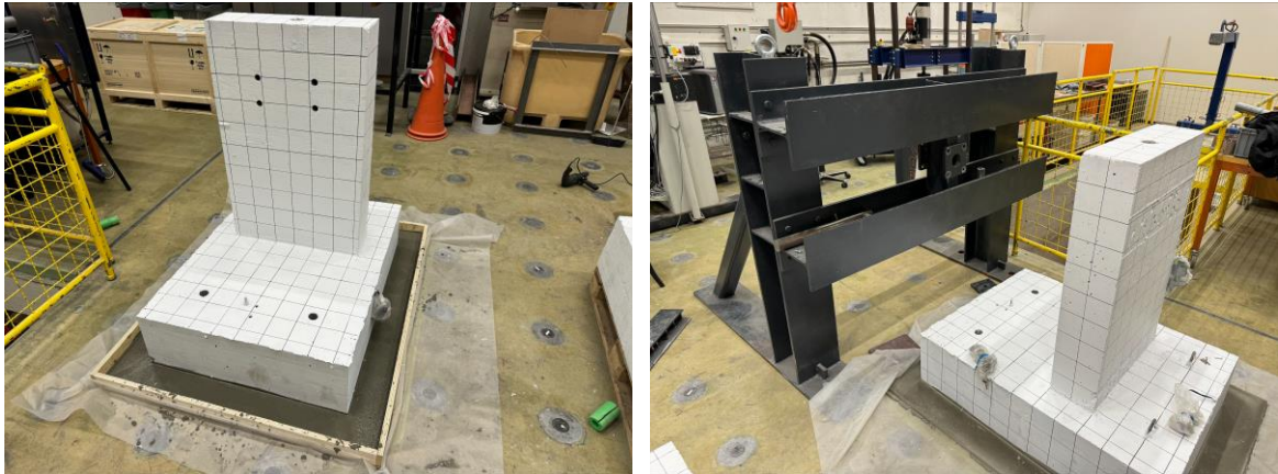
Mynd 3-2: FSL-SS í undirbúning & viðspyrnu komið fyrir við prófstykki.
