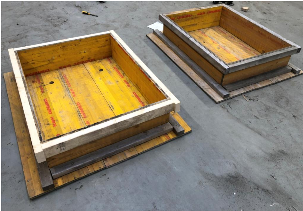
Mynd 2-7: Sökkulmót prófstykkja samansett.
