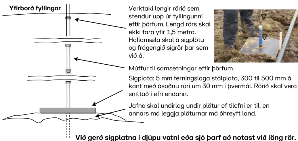
Mynd 2 – Skýringarmynd af uppsetningu sigplötu (Vegagerðin, 2021c).
