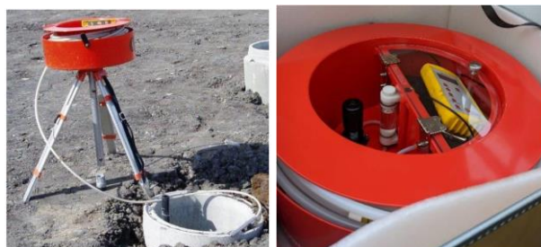
Mynd 9 – Dæmi um sigslöngumælitæki í folti (Statens vegvesen, 2018) og horft ofaní tromlu mælitækis í eigu Vegagerðarinnar.
