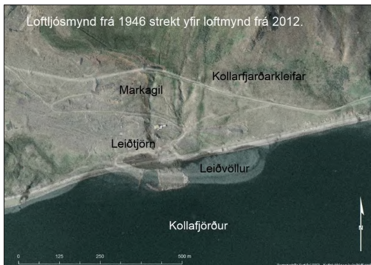
Mynd 35. Þegar loftljósmynd frá 1946 var hnitsett (strekktt) yfir loftmynd frá 2012 má sjá breytingar sem hafa orðið á strandlínunni á þeim tíma líklega vegna landsigs, sandnáms og vegagerðar.
