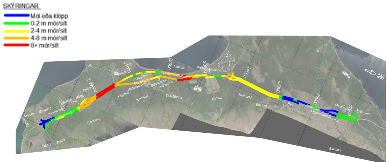
MYND 3.10 Yfirlitsmynd, áætlað dýpi á klöpp í veglínun, byggt á fyrirbyggjandi rannsóknum. Búast má við talsverðu sigi á rauðum og appelsínugulum svæðum af völdum ferginga.
