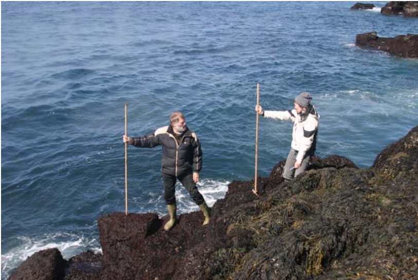
3. mynd. Hæðarmunur í fjöru metin með hæðarstikum sem bornar eru við sjóndeildarhring.
