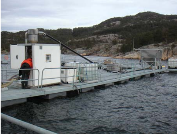
Mynd 7.4. Búnaður frá Seafarm Products í sjókvíeldisstöðinni Eurofish í Noregi sem notaður er til að beyta upp í þurrfóðri fyrir þorsk (Ljósmynd: Gunnar Örn Kristjánsson).
