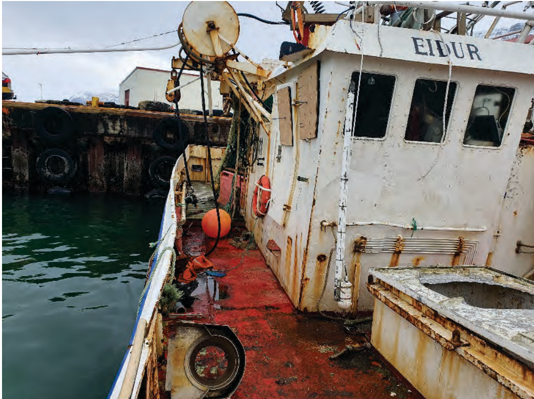
Mynd 28. Eiður og hliðin sem sneri að flóðinu. Hliðin og stýrishús beyglaðist inn og rúður brotnuðu.
