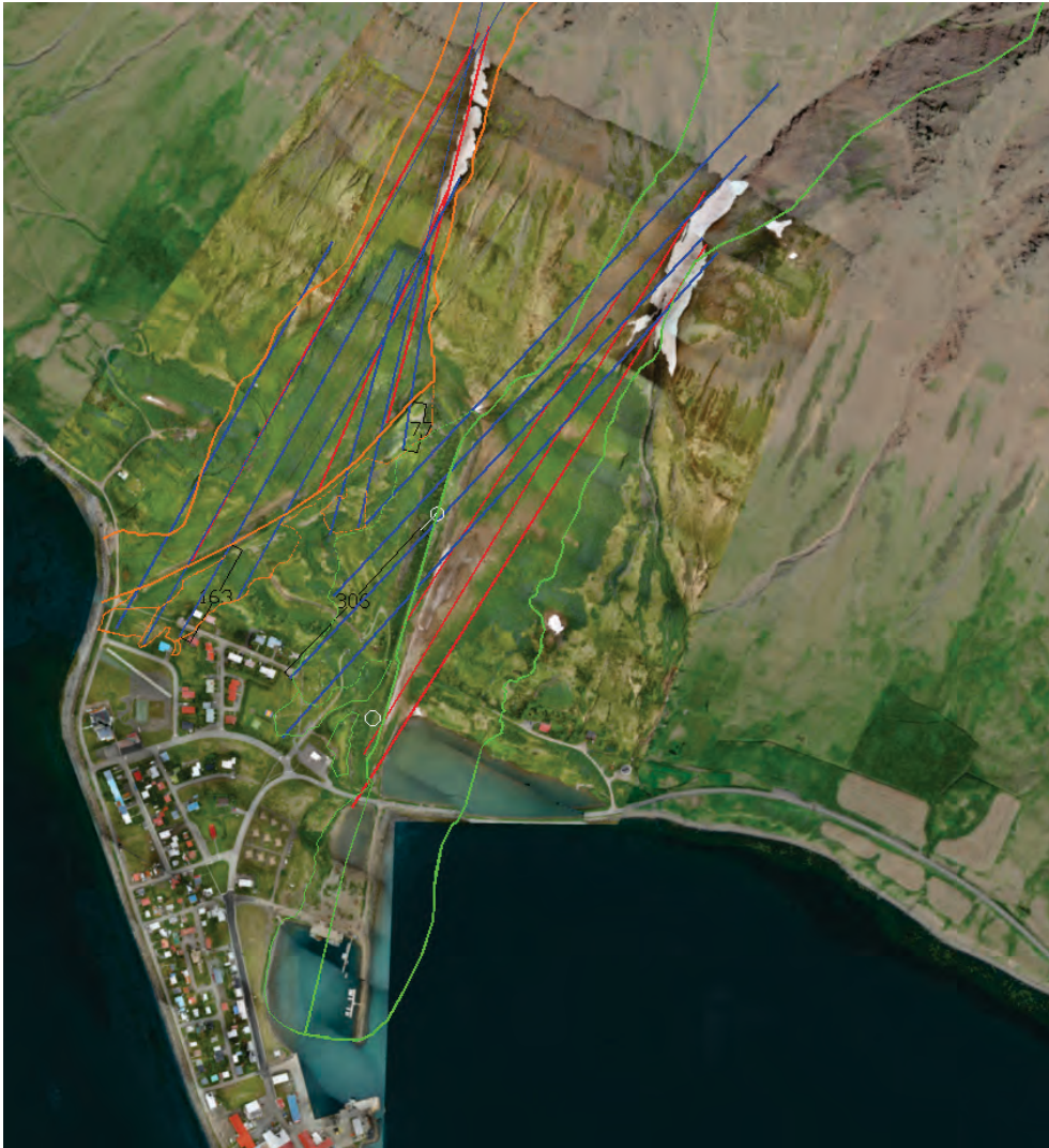
Mynd 19. Kort sem sýnir stefnur á iðufaldi (blátt) og þétta kjarna (rautt) snjóflóðanna úr Skollahvilft og Innra-Bæjargili. Í Skollahvilft lendir iðufaldurinn á varnargarðinum með stærra leiðihorni (meira þvert á) en þétti kjarninn. Það sama á við efst á leiðigarði Innra-Bæjargils. Hvítu hringirnir sýna staðsetningu radarmastranna og stefnan á efra mastrinu þar sem þá lá brotið er einnig sýnd. Myndvinnsla: Kristín Martha Hákonardóttir, byggt á túlkun Betty Sovilla við Svissnesku snjóflóðarannsóknastofnunina SLF í Davos
