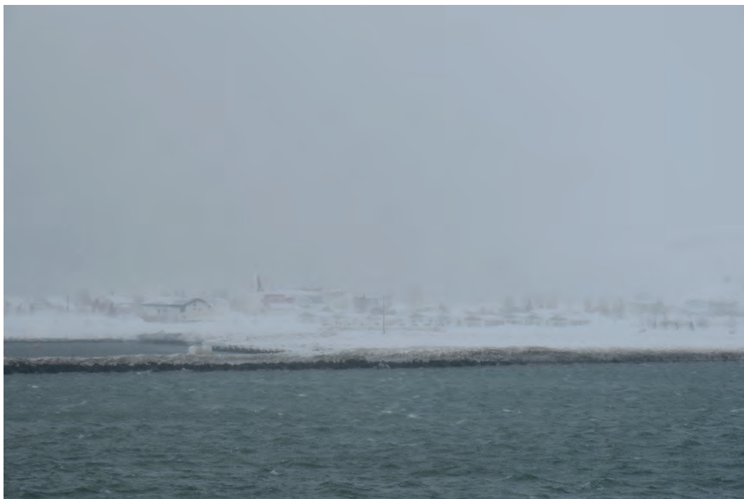
Mynd 27. Smábátahöfnin, flotbryggjan og allir bátar farnir. Flóðsnjór sést á grjótgarði. Ljósamastur fallið og skúr/gámar á kafi. Tréstaurn stendur. Olíutankur stendur. Mynd tekin úr varðskipi um hádegi 15.1.
