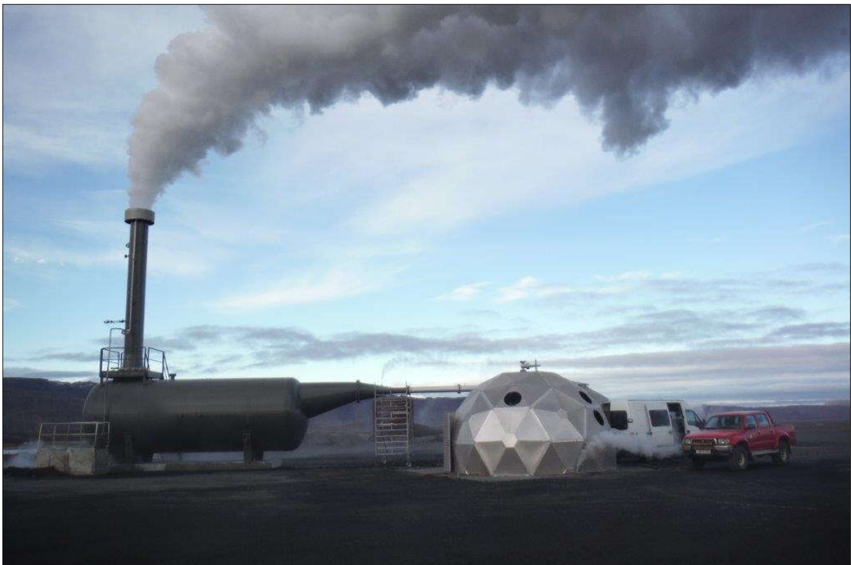
Mynd 9: Borhola ÞG-11. Dæmi um hljóðdeyfi á borholu.
