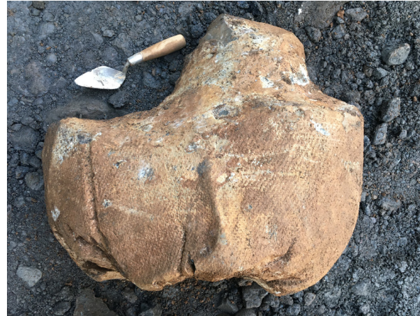
Mynd 17. Á 6m löngum kafla innanum grjótið í sjóvarnargarði [027] á svæði G komu í ljós nokkrir steypuklumpar. Þeir virtust vera úr óblandaðri steypu sem hugsanlega hefur harnað í þeim umbúðum sem hún kom í.
