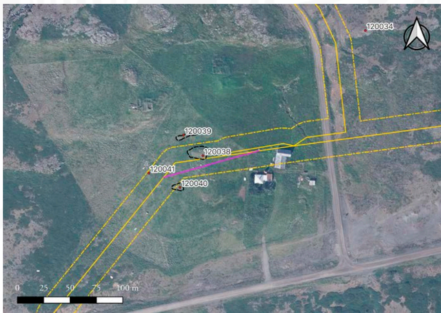
Kort 12: Hella DA-120. Tillögð breyting á strengleið er merkt með fjólublárrí línu.
