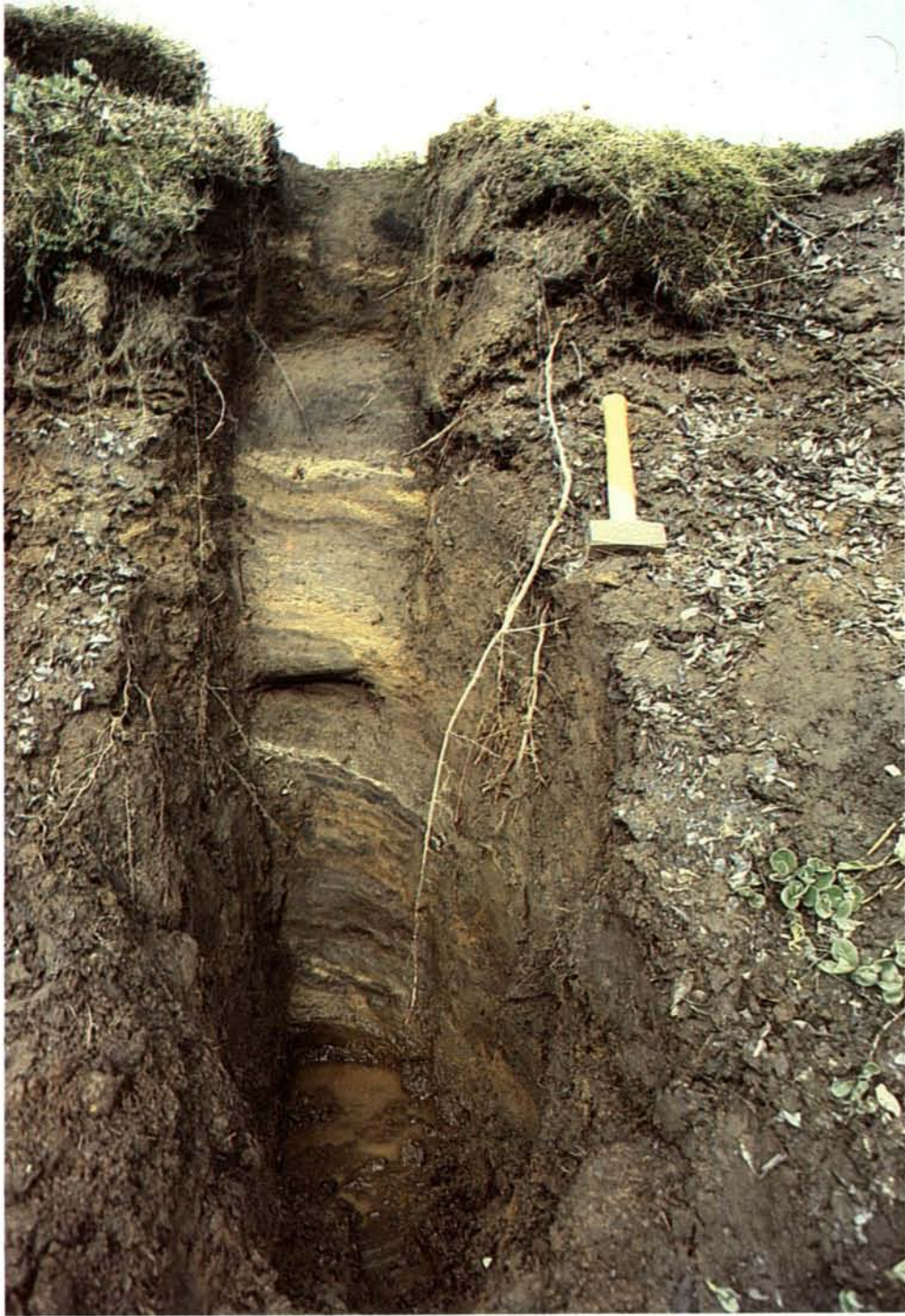
5. mynd. Jarðvegssnið í víðiheiði við Dratthalavatn. Sífreri byrjar á um 30 cm dýpi (ofan við hamarinn), og er um 60 cm þykkur. Neðri mörkin má greina sem skugga ofan við hvítt öskulag. Jarðvegur er allur sendinn og fínkornóttur.
